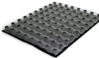
Aus tiefgezogenem HDPE ohne Wasserspeicherfunktion mit oberseitigem Kanalsystem und Vlieskaschierung sowie unterseitig aufgeklebter PE-Folie zur Dränage unter Gehbelägen auf Dachflächen. Einsatz auch als vertikale Gebäudedränage auf bituminöser oder sonstiger Abdichtung.
