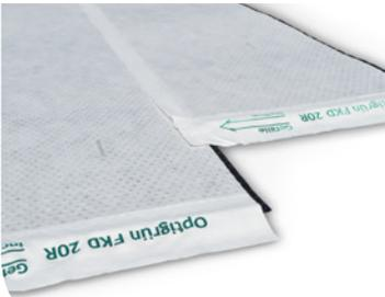
Aus tiefgezogenem Recycling-HDPE mit Wasserspeicherfunktion, Kanalsystem zur Dränage sowie aufkaschiertem Filtervlies FIL 100. Für den Einsatz in Extensiv-Begrünungen in mehrschichtiger Bauweise. Mit seitlichen Noppenverbindern und Vliesüberlappung.
