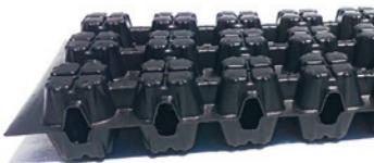
Integrierter Dauerwasserspeicher von 3 bzw. 6 l/m<sup>2</sup>. Lieferung als Platte mit 2 x 1 m, die zur Erzielung des Hohlräumvolumens auf 2 x 0,5 m zusammengeklappt wird. Nicht geeignet für den Einsatz unter Geh- oder Fahrbelägen.
