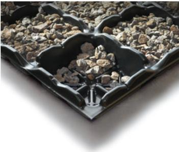
Drän- und Wasserspeicherelement aus HDPE-Recycling-Regenerat mit hohem Wasserspeicher. Hochbelastbar mit unterseitigem Kanalsystem zur Drainierung und oberseitigen Diffusions- und Entwässerungsbohrungen.
